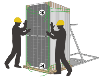
6.剪断所有横向打包带
