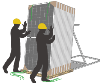
8.剪断剩余打包带，使组件靠在靠架上
