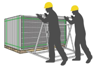
3 放置拆箱靠架，注意靠架应宽于或高于组件防止顶撞玻璃造成组件
