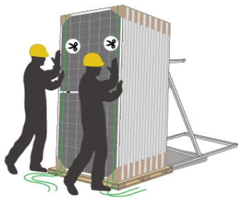
7.剩余1-2根竖向打包带时，缓慢推动组件向靠架倾斜
