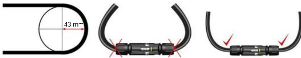
图4. 电缆的最小弯曲半径。
